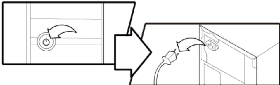
1. 请关闭您的台式机电脑电源并移除电源线。
