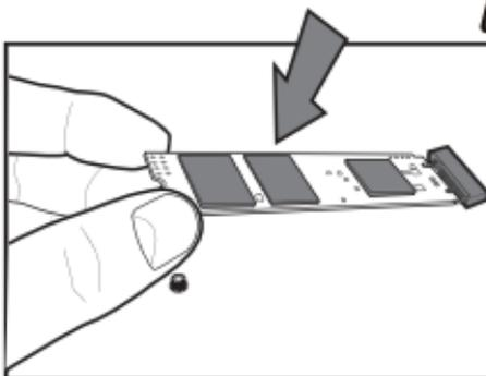
6. 將KLEVV科賦M.2固态硬盘插入插槽后，
